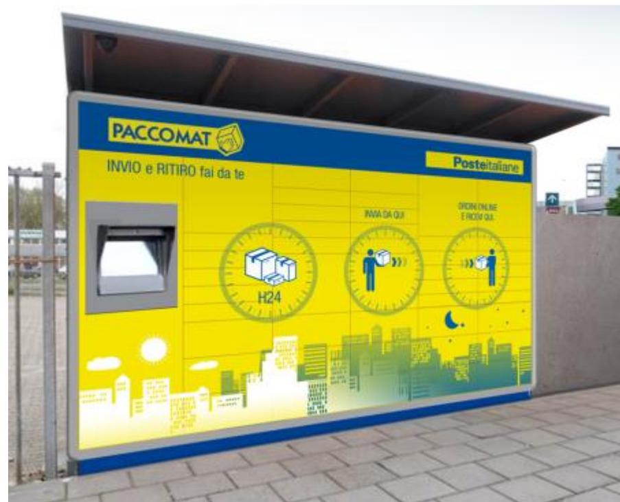
Ogni chiosco alloggia **46 celle** di differenti dimensioni, capaci di alloggiare pacchi fino a 15 kg
