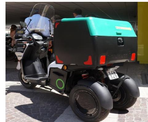
(\*): **Veicoli a tre ruote (categoria L2e)** aventi una velocità massima per costruzione non superiore a 45 km/h e caratterizzati da un motore, la cui potenza nominale continua massima è inferiore o uguale a 4kW per i motori elettrici.
