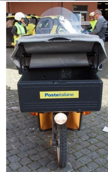
(\*): **Veicoli a tre ruote (categoria L2e)** aventi una velocità massima per costruzione non superiore a 45 km/h e caratterizzati da un motore, la cui potenza nominale continua massima è inferiore o uguale a 4kW per i motori elettrici.
